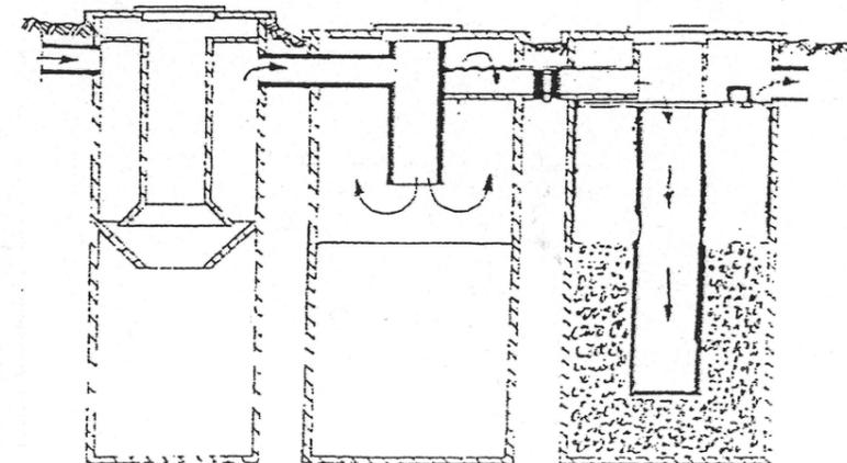
n. 1 bacino primario Tipo imhoff di chiarificazione e digestione fanghi.
